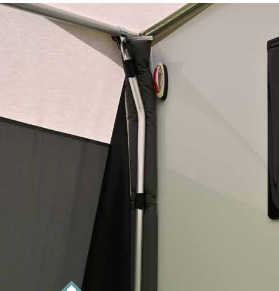
Gebogene Stangen sorgen mit einem Schaumstoffstreifen für einen winddichten Anschluss an die Wohnwagenwand.
